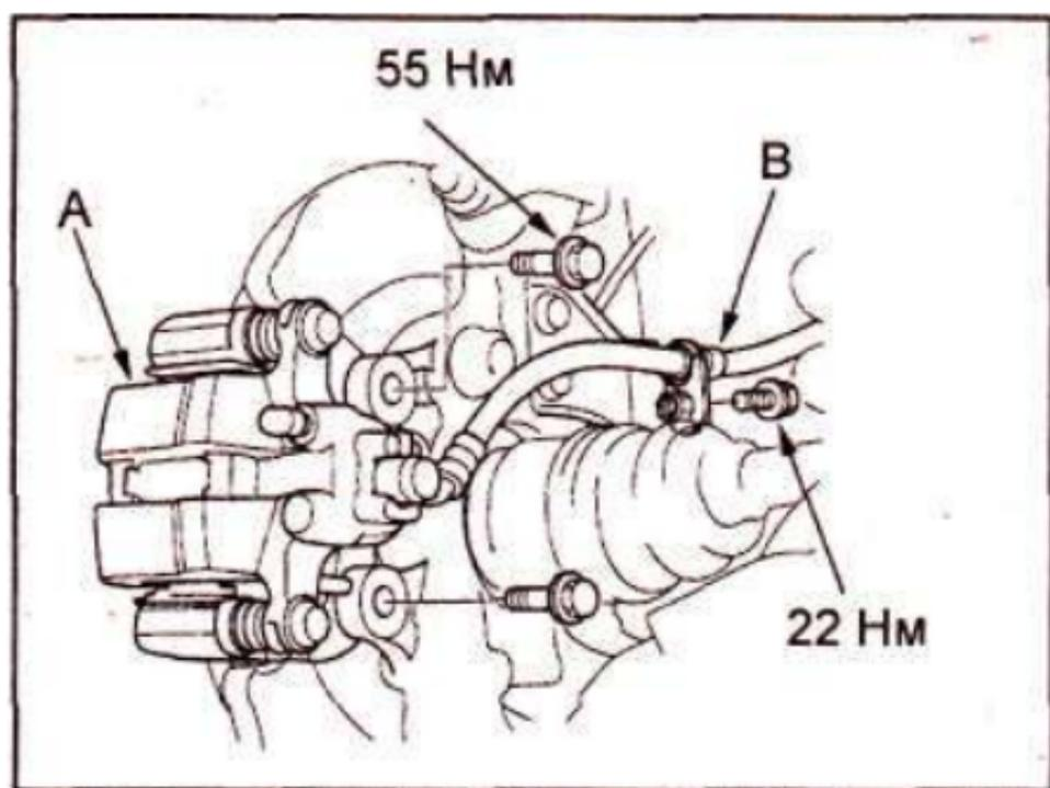
4. Отверните болты, снимите тормозной суппорт (A) и подвесьте его в стороне.
