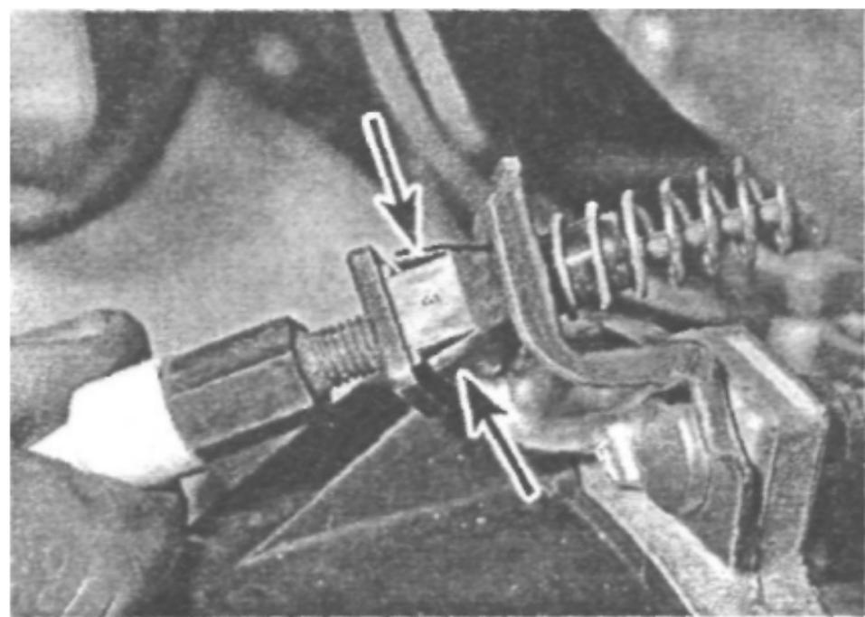
**Рис. 13.8. Сожмите пластмассовые лепки и извлеките трос из опорного кронштейна**
