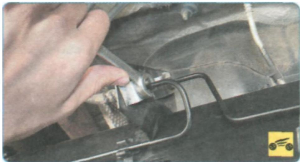
1. Для того чтобы заменить шланг тормозного механизма заднего колеса, отверните...
