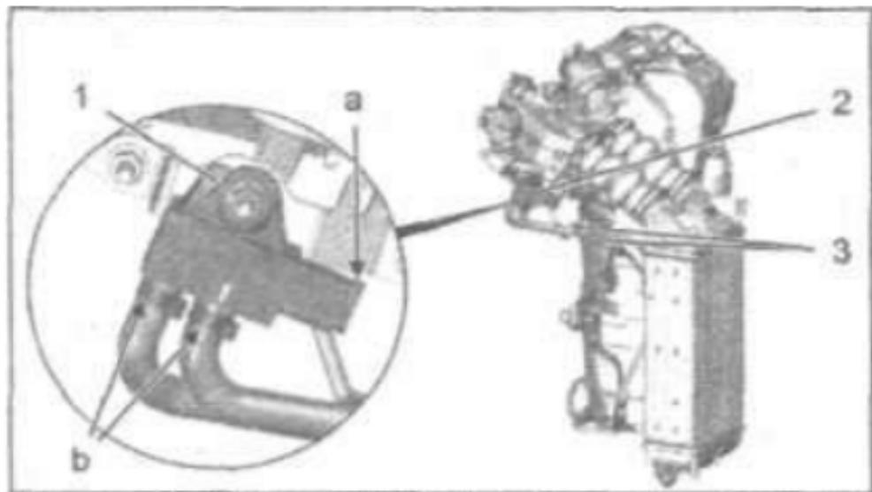
Отсоедините разъем (в зоне «а»). Снять гайку (1) крепления датчика давления (2) ОГ. Отодвинуть датчик давления ОГ (2).
