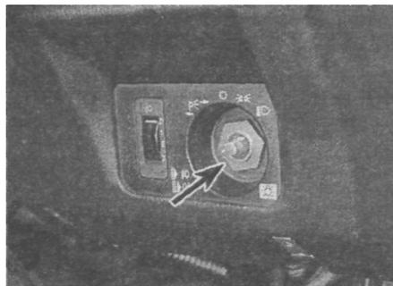
**Рис. 42.8.** Отверните гайку крепления переключателя света [показана стрелкой]
