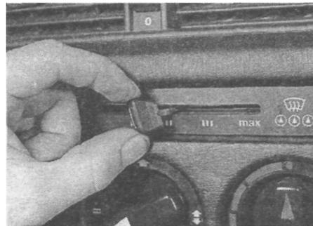
Рис. 42.17. Снимите кнопку переключателя вентилятора отопителя
