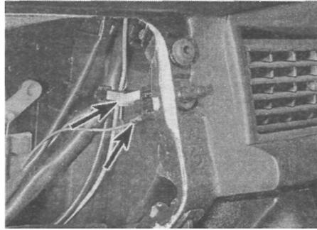
Рис. 42.13. Отсоедините провода плафона освещения ящика для перчаток
