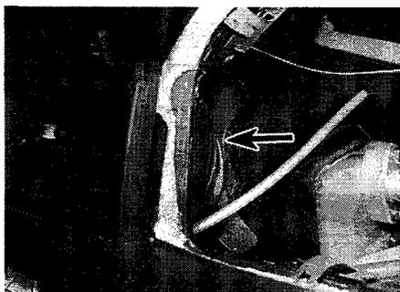
**Рис. 42.24. Отверните болт за крышкой ящика для перчаток [показан стрелкой]**
