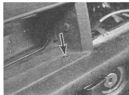
Рис. 42.20. Отверните винты в центре отверстия вентиляции [показан стрелкой]
