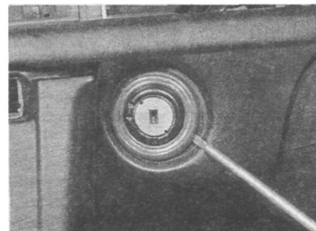
Рис. 42.21. Подденьте облицовку замка зажигания
