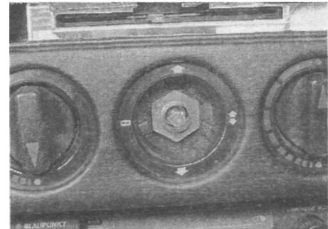
Рис. 42.18. Отверните гайки крепления блока управления отопителем
