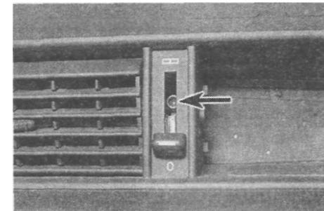
Рис. 42.22. Отверните болт (показан стрелкой) через прорезь для рычага
