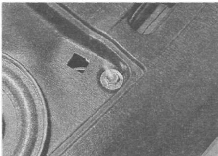
**Рис. 42.7.** Отверните верхний болт рядом с динамиком
