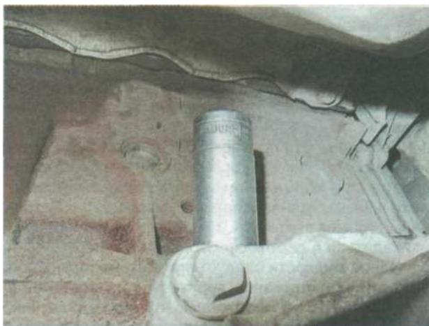
**5.** С помощью воротка ослабляем затяжку датчика, затем от руки выворачиваем датчик из блока цилиндров.
