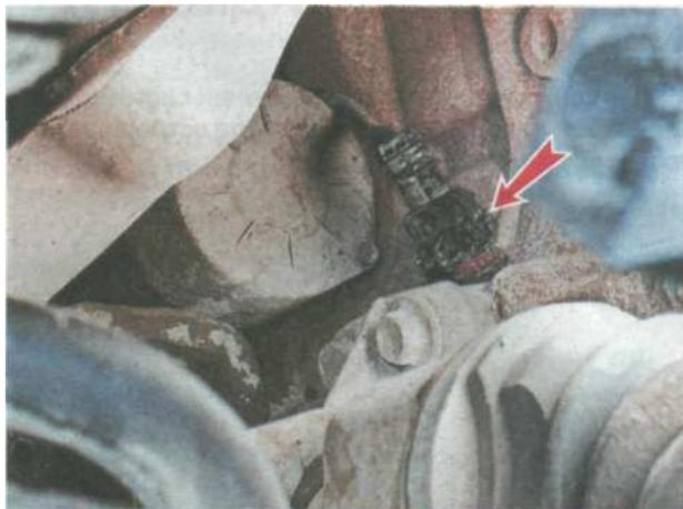
**3.** Проверяем состояние выводов колодки жгута проводов. Для удаления окислов обрабатываем их специальным средством для очистки и защиты электрических контактов.
