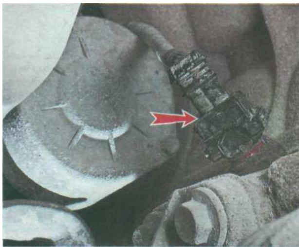
В случае неисправности датчика **блок управления электрооборудованием** будет получать неверные сигналы о количестве масла в двигателе. Необходимость в проверке датчика может возникнуть:
