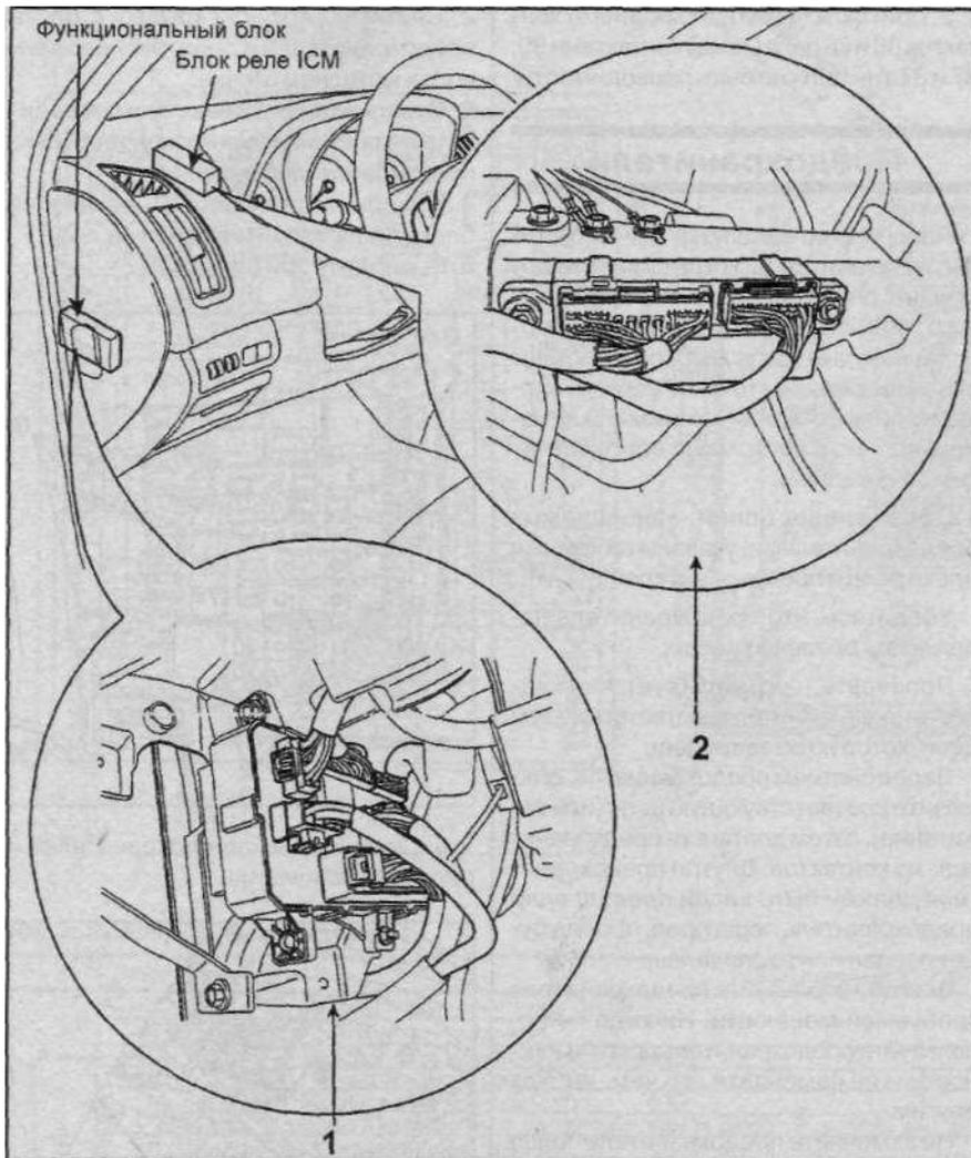
**Расположение блоков реле в салоне автомобиля:** 1 - реле заднего освещения, реле стеклоподъемников, реле отопителя, реле двери багажного отделения; 2 - реле центральной блокировки замков, реле размораживателя ветрового стекла, реле задних противотуманных фонарей, реле звукового сигнала предупредительной противогононной сигнализации, реле датчика дождя, блок реле Built-in-ICM
