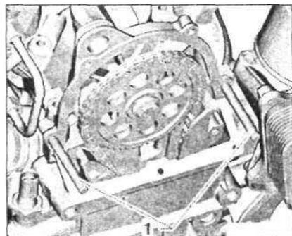
Полоска герметика должна быть толщиной 2...3 мм и должна быть нанесена с внутренней стороны отверстий для болтов. В области -стрелок- нанести чуть больше герметика.
