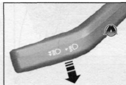
Для переключения между ближним и дальним светом фар потяните рычаг подрулевого переключателя до упора по направлению к рулевому колесу.
