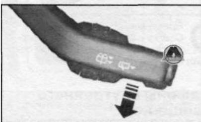
Потяните рычаг до упора по направлению к рулевому колесу и удерживайте рычаг, чтобы привести в действие стеклоомыватель.
