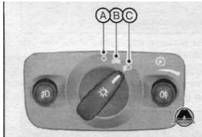
**A.** Вентилятор выключен. **B.** Передние и задние габаритные фонари. **C.** Фары.
