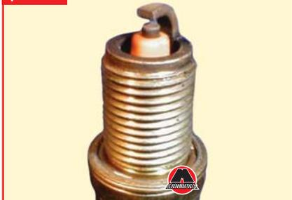
На фото №1 изображена свеча зажигания, вывернутая из нормально работающего двигателя. Юбка центрального электрода имеет светлорыжий цвет, нагар и отложения минимальны, полное отсутствие следов масла. Такой двигатель обеспечивает оптимальные показатели расхода топлива и моторного масла.
