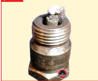
Свеча зажигания, изображенная на фото №8, имеет электрод, покрытый золеными отложениями. При этом цвет отложений не играет решающей роли. Причина такого нароста – сгорание масла вследствие износа или залипания маслосъемных поршневых колец. На двигателе наблюдается повышенный расход масла, из выхлопной трубы валит синий дым. Процедура замены поршневых колец описывается в главе «Механическая часть двигателя». Изд-во "Monolith"
