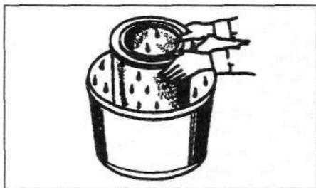
б) Промойте фильтр в воде и пропустите сжатым воздухом.
