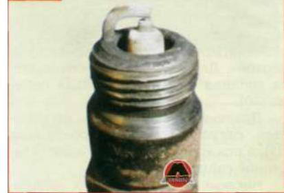
На фото №3 изображена свеча из двигателя, топливовоздушная смесь которого в отличие от предыдущего случая слишком обеднена. Цвет электрода такой свечи зажигания от светло-серого до белого. При работе на бедной смеси эффективная мощность двигателя падает. При использовании такой смеси она долго не воспламеняется, а процесс сгорания происходит с нарушениями, сопровождающимися неравномерной работой двигателя.
