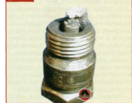
Свеча зажигания, изображенная на фото №8, имеет электрод, покрытый зольными отложениями. При этом цвет отложений не играет решающей роли. Причина такого нароста - сгорание масла вследствие износа или залипания маслосъемных поршневых колец. На двигателе наблюдается повышенный расход масла, из выхлопной трубы валит синий дым. Процедура замены поршневых колец описывается в главе «Механическая часть двигателя». Издательство «Монолит»
