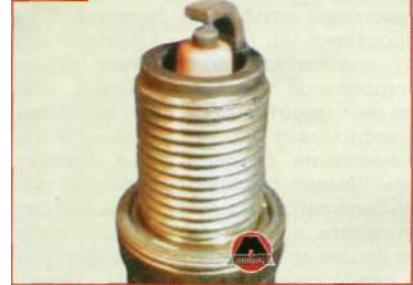
На фото №1 изображена свеча зажигания, вывернутая из нормально работающего двигателя. Юбка центрального электрода имеет светло-коричневый цвет, нагар и отложения минимальны, полное отсутствие следов масла. Такой двигатель обеспечивает оптимальные показатели расхода топлива и моторного масла.
