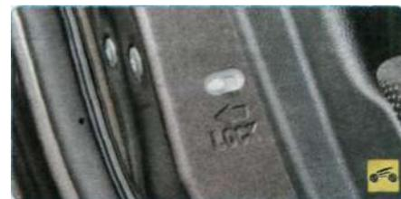
Если на заднем сиденье находятся дети, при открытой двери переместите назад (в направлении стрелки над надписью «LOCK») рукоятку выключателя замка и закройте дверь. В этом случае при не нажатых клавишах блокировки можно открыть дверь только снаружи, внутренней ручкой замок отпереть невозможно.
