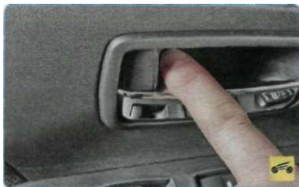
...и изнутри, повернув вперед на 90° (до щелчка) клавишу блокировки на внутренней ручке привода замка...
