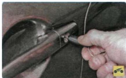
Двери можно заблокировать снаружи ключом, повернув против часовой стрелки цилиндр выключателя замка двери водителя...
