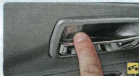
...повернув назад на 90° (до щелчка) клавишу блокировки на внутренней ручке привода замка...
