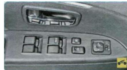
Центральный блок управления электростеклоподъемниками расположен в подлокотнике двери водителя. Блок объединяет выключатели электростеклоподъемников всех дверей.
