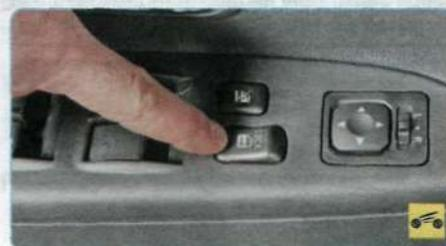
...или нажав на задний край клавиши блокировки на подлокотнике двери водителя.
