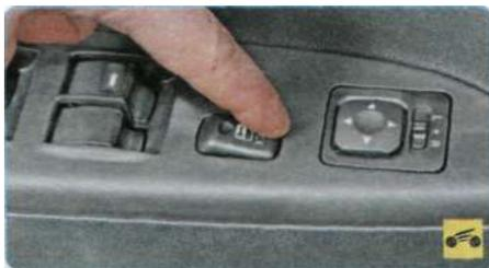
...или клавишей выключателя блокировки, расположенной на подлокотнике двери водителя, нажав на ее передний край.
