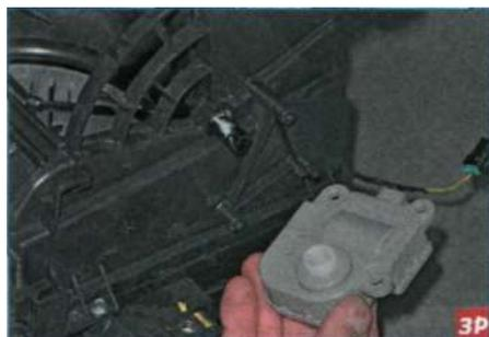
...и снимаем привод.
