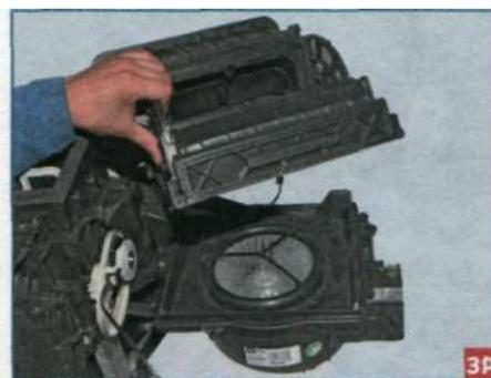
...и снимаем корпус заслонки рециркуляции.
