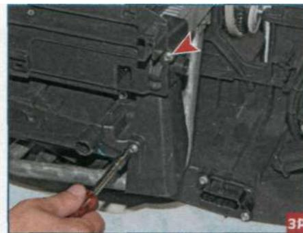
Головкой «на 5,5» отворачиваем два самореза...
