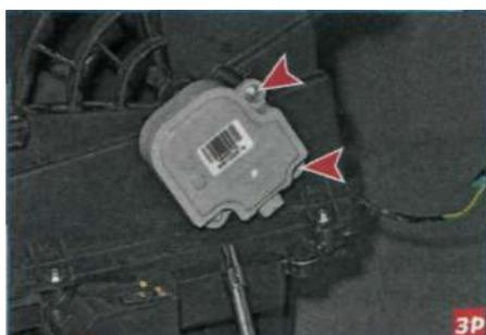
Головкой «на 5,5» отворачиваем три самореза...
