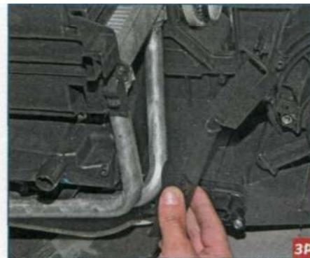
...и снимаем кожух трубок радиатора отопителя.
