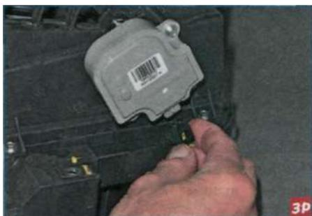
...отжав фиксатор колодки проводов, отсоединяем колодку от разъема привода.
