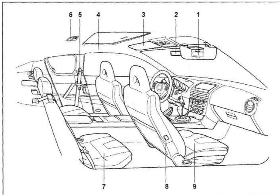
Расположение компонентов в салоне. 1 - косметическое зеркало, 2 - внутреннее зеркало заднего вида, 3 - солнцезащитный козырек, 4 - боковая шторка безопасности, 5 - ремень безопасности переднего сиденья, 6 - лампа освещения салона, 7 - заднее сиденье, 8 - боковая подушка безопасности переднего пассажира, 9 - переднее сиденье.
