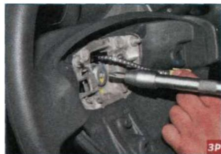
**Ключом Torx T-50 отворачиваем на несколько оборотов винт крепления рулевого колеса.**
