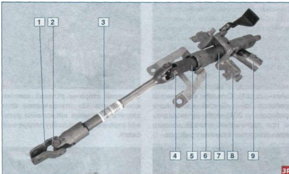
**Рулевая колонка с промежуточным валом:** 1 - соединительная муфта; 2 - нижний карданный шарнир; 3 - промежуточный вал; 4 - верхний карданный шарнир; 5 - вал рулевой колонки; 6 - передний кронштейн крепления колонки; 7 - труба; 8 - задний кронштейн крепления колонки; 9 - гнездо выключателя зажигания
