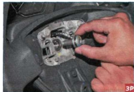
**Полностью отворачиваем винт крепления рулевого колеса.**
