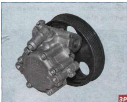
**Насос гидроусилителя рулевого управления**
