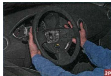
**Покачивая, тянем на себя рулевое колесо и сдвигаем его по шлицам вала.**
