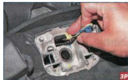
**Продвигаем колодку с проводами подушки безопасности через отверстие в ступице рулевого колеса...**
