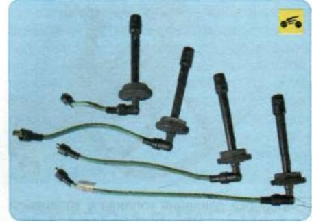
7. Если искры нет, замените провода высокого напряжения новыми, можно предварительно попробовать установить проверенные провода с «рабочей» машины.
