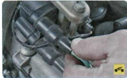
2. При выключенном зажигании проверьте целостность и посадку проводов высокого напряжения в катушках зажигания.
