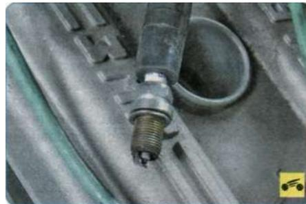
5. Прижмите свечу резьбовой частью к металлической крышке головки блока. Попросите помощника провернуть стартером коленчатый вал двигателя.
