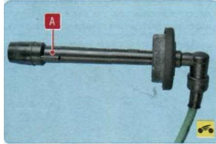
Осмотрите поверхность А наконечника свечи зажигания на наличие пробоя изолятора.
