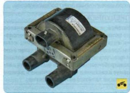
8. Если после замены проводов искра не появилась, замените соответствующую катушку зажигания (см. «Снятие и установка катушек зажигания», с. 236).
