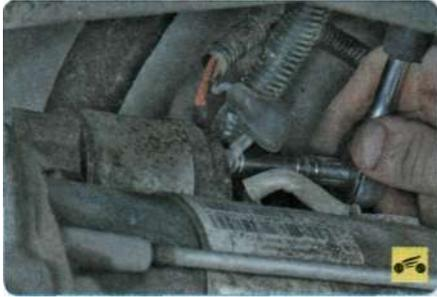
...и затяжку контактных соединений в цепи стартера.
