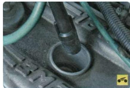
3. Проверьте наличие искры на свечах зажигания. Для этого снимите наконечник провода с любой свечи зажигания.
