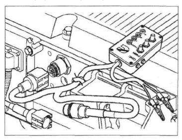
• Черный контакт на корпусе прибора - «масса». Белые контакты предназначены для измерения сопротивления соответствующих соленоидов в режимах работы моторного тормоза 1, 2и3.
