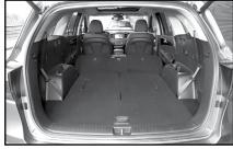
Электропривод двери багажника с функцией Hands Free срабатывает при приближении ключа зажигания. Объем багажного отсека пятиместной версии в обычном состоянии составляет 660 л. Багажник семиместной версии гораздо скромнее — всего 142 л. Однако, если сложить спинки сидений третьего ряда в ровный пол, то получится уже 605 л. А при складывании сидений двух задних рядов полезный объем грузового отсека составит 1762 л.
