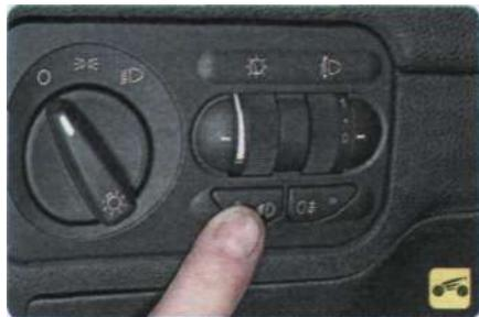
При нажатии на кнопку выключателя 5 (см. рис. 1.9) включаются противотуманные фары, если включено наружное освещение. При повторном нажатии на кнопку фары выключаются.
