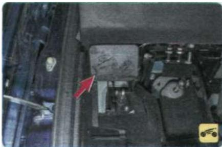
28 - рукоятка привода замка капота (см. «Капот», с. 31).
