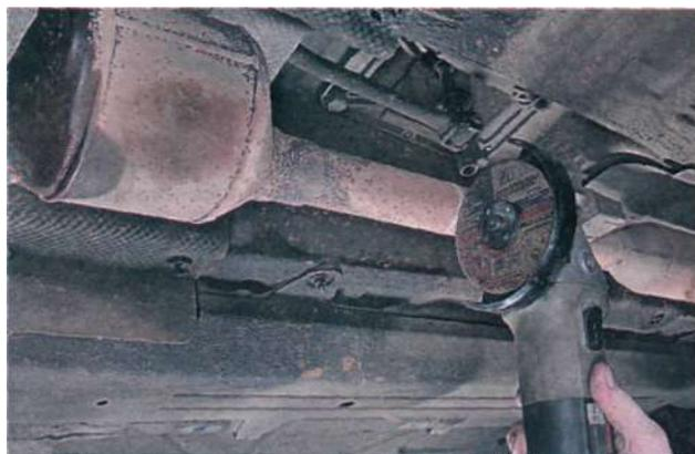
3. Отсоединяем подушку подвески от кронштейна основного глушителя (с. 162, «Подушки подвески элементов системы выпуска — замена») и снимаем глушитель. Аналогично снимаем дополнительный глушитель.
