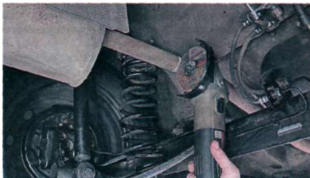
При замене дополнительного глушителя также разрезаем трубу, соединяющую его с каталитическим нейтрализатором.
