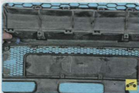
19. ...и отожмите фиксаторы крепления нижней облицовки радиатора.
