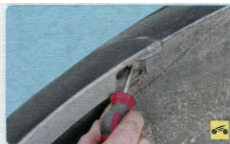
4. В арках колес с обеих сторон выверните по одному винту крепления бампера к кузову.
