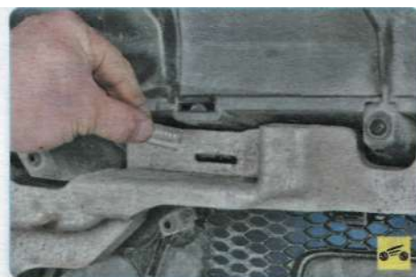
22. ...и снимите фиксаторы крепления энергопоглощающего элемента.
