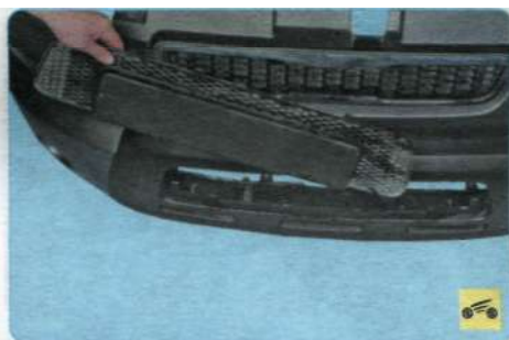
20. Снимите нижнюю облицовку радиатора.
