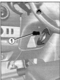
Потяните рычаг (1; и установите рулевое колесо в нужное положение.
