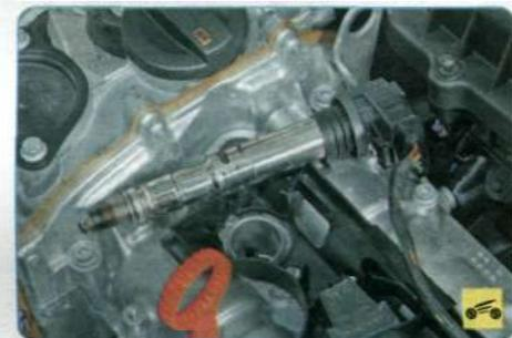
8. Присоедините поочередно корпуса свечей к «массе» автомобиля (например, к корпусу распределительных валов). Попросите помощника провернуть стартером коленчатый вал двигателя.
