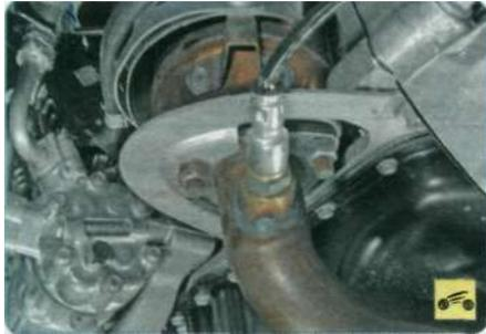
...и диагностического датчиков концентрации кислорода (лямбда-зондов) - увеличение расхода топлива, снижение мощности двигателя, неустойчивая работа на холостом ходу, возможно повреждение каталитического нейтрализатора отработавших газов;
