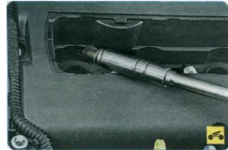
5. Выверните свечи зажигания (см. «Замена и обслуживание свечей зажигания», с. 193), осмотрите свечи и сравните их внешний вид с фотографиями, приведенными в подразделе «Диагностика состояния двигателя по внешнему виду свечей зажигания», с. 44. Если свеча черная и влажная, ее нужно заменить.
