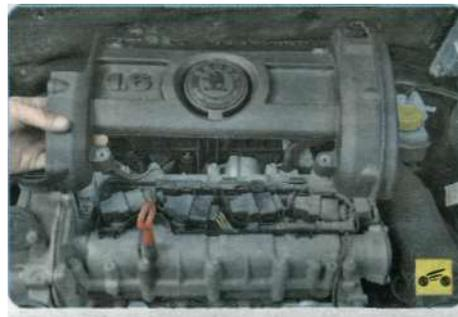
2. Сожмите фиксаторы и снимите декоративную крышку головки блока цилиндров.
