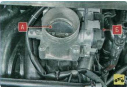
Однако необходимо отметить, что чаще всего эта неисправность бывает вызвана отказом регулятора холостого хода, установленного в крышке Б дроссельного узла, из-за загрязнения заслонки А или подсосом постороннего воздуха через неплотные соединения шлангов, присоединенных к впускной трубе. Если очисткой дроссельной заслонки или подтяжкой хомутов шлангов восстановить холостой ход не удалось, замените дроссельный узел в сборе (см. «Снятие и установка дроссельного узла», с. 106).
