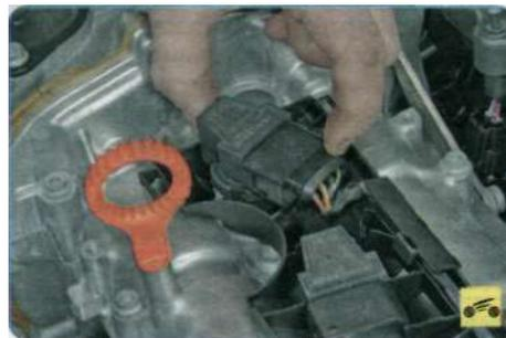
3. Проверьте посадку катушек зажигания на свечах и надежность присоединения колодок жгута проводов к катушкам зажигания.
