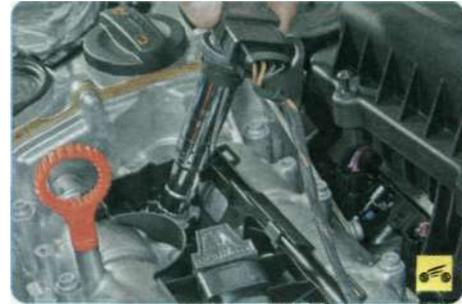
4. Если посадка катушек на свечах и присоединение колодок проводов к катушкам надежны, снимите катушки зажигания.
