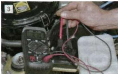
**Проверка вторичной обмотки катушки зажигания** (фото 3): ее сопротивление должно быть в пределах 11+1,5 кОм. Сопротивление первичной обмотки (между двумя клеммами "папа") - 0,5+0,05 Ом.
