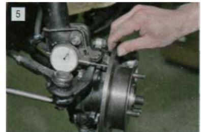
**Проверка биения тормозного диска** (фото 5): прокручиваем диск, следя за показаниями жестко закрепленной на стойке индикаторной головки. Максимально допустимое биение у кромки диска - 0,15 мм. Если оно больше, диск протачивают, но при этом его толщина должна остаться не менее 7,8 мм. Покачивая диск на себя и от себя, проверяем отсутствие осевого люфта в подшипнике.
