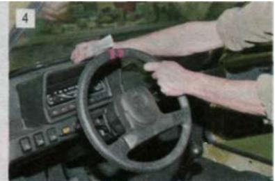
**Проверка люфта в рулевом управлении.** Покачивая рулевое колесо руками и следя за тем, чтобы колеса автомобиля при этом не перемещались, замеряем максимальный люфт колеса (фото 4), который не должен превышать 5° (12 мм по ободу).
