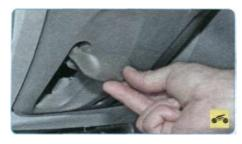
Для регулировки разблокируйте рулевую колонку, подняв рычаг вверх...
