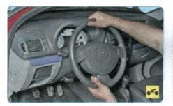
...отрегулируйте положение рулевого колеса по углу наклона таким образом, чтобы были видны все приборы в комбинации приборов, а руки на рулевом колесе находились в наиболее удобном положении...
