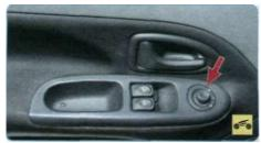
Джойстик управления зеркалами расположен на подлокотнике двери водителя в общем блоке с переключателями управления электростеклоподъемниками. Для регулировки положения зеркал необходимо, чтобы ключ в выключателе зажигания находился в положении «А» или «М».
