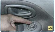
Для регулировки положения зеркал наклоните в соответствующую сторону рукоятку джойстика. При отпускании рукоятка автоматически возвращается в среднее положение. По окончании регулировки поверните рукоятку в среднее положение.
