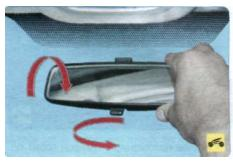
Положение внутреннего зеркала заднего вида регулируют поворотом в нужную сторону на шарнире кронштейна.
