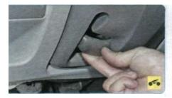
...затем заблокируйте рулевую колонку, опустив рычаг до упора вниз.
