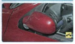
Для уменьшения габарита автомобиля при парковке в местах с интенсивным движением наружное зеркало можно сложить, повернув на шарнире рукой назад...
