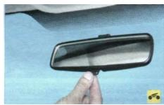
Для предотвращения ослепления светом фар движущегося сзади транспорта в темное время суток можно поворотом рычага изменить положение оптического элемента на его опоре. Для этого поверните рычаг на себя.
