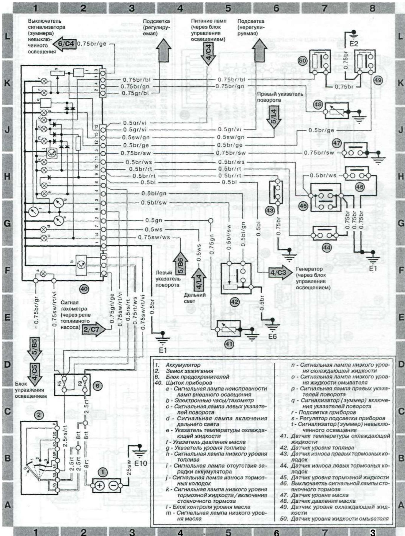
Схема 3. Приборы и сигнальные лампы
