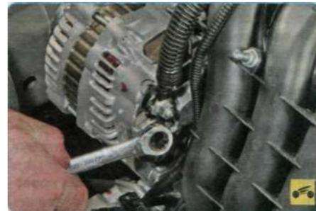
5. ...и к генератору. Провода могут быть оборваны, обломаны внутри изоляции либо с окисленными или ненадежными контактами. Устраните неисправность и пустите двигатель. Если появился ток зарядки, можно продолжать движение.
