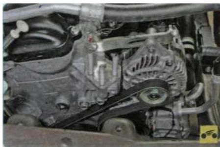
1. Проверьте, не оборван ли ремень привода генератора. Если произошел обрыв, замените ремень (см. «Проверка натяжения и замена ремня привода вспомогательных агрегатов», с. 79).
