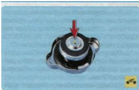
Поэтому раз в год промывайте пробку радиатора проточной водой, а также периодически проверяйте подвижность штока выпускного клапана, нажав на тарелку клапана пальцем. Если появились сомнения, замените пробку. Очевидно, что если на перегретом двигателе снять пробку радиатора и по времени это действие совпадет с тепловым ударом, то вскипание жидкости и образование воздушных пробок в системе охлаждения будет гарантировано.
