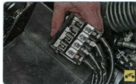
6. Если ремень натянут нормально, проверьте, не перегорели ли плавкие вставки в дополнительном блоке, расположенном на аккумуляторной батарее. Если плавкие вставки перегорели, замените их, пустите двигатель и проверьте, погасла ли лампа разряда аккумуляторной батареи. Если лампа погасла, можно продолжать движение.
