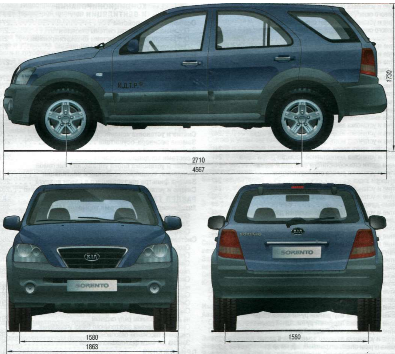
Рис. 1.1. Габаритные размеры автомобиля
