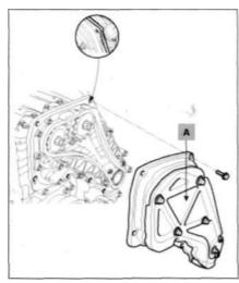
7. Установить специальное приспособление [09331-4A000] на верхнюю часть внутренней крышки цепи привода ГРМ, как показано на рисунке. Используя приспособление, снять топливный насос высокого давления вместе с приводной звездочкой.
