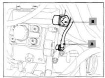
5. Отвернуть три болта крепления [A].
