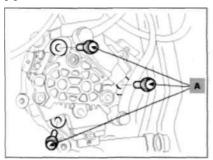
6. Отвернуть болты крепления и снять верхнюю крышку цепи привода ГРМ [А] [см. Глава 2 «Двигатель»].
