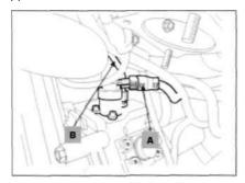
4. Отсоединить разъем подводящего топливного патрубка [A] и возвратного патрубка (B), как показано на рисунке.
