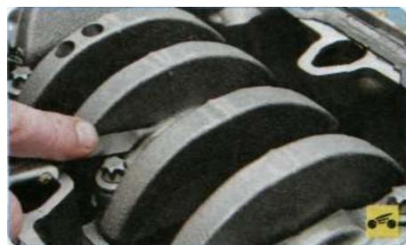
26. Проверьте боковой зазор шатуна, он должен быть 0,070-0,242 мм. Увеличенный зазор указывает на чрезмерный износ щек кривошипов коленчатого вала. В этом случае замените коленчатый вал.
