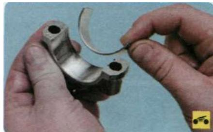
20. Установите шатунные вкладыши в крышки шатунов, совместив установочный усик вкладыша с выемкой на крышке.
