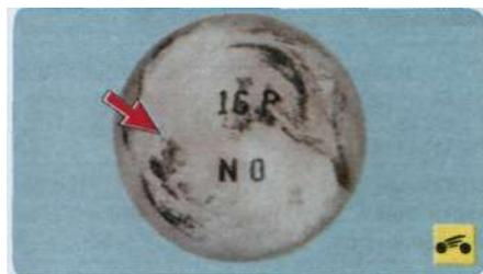
При установке поршней в цилиндры метка (стрелка) на поршне и надписи на шатуне должны быть обращены к передней части двигателя.
