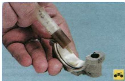
21. Смажьте моторным маслом шатунные вкладыши в крышках шатунов и шатунные шейки коленчатого вала.
