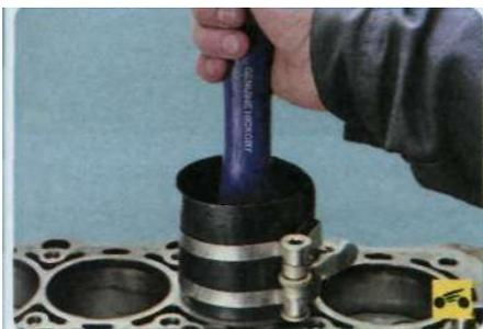
19. ...нажмите (например, ручкой молотка) на поршень и сдвиньте его из оправки в цилиндр. Аналогично установите поршни в остальные цилиндры.
