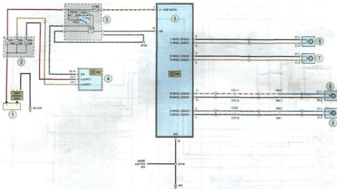
Схема 6. Антиблокировочная система тормозов (ABS): 1 – аккумуляторная батарея; 2 – блок плавких вставок в моторном отсеке; 3 – монтажный блок в моторном отсеке; 4 – блок управления кузовным электрооборудованием; 5 – гидроэлектронный модуль ABS; 6 – датчик частоты вращения левого переднего колеса; 7 – датчик частоты вращения правого переднего колеса; 8 – датчик частоты вращения правого заднего колеса; 9 – датчик частоты вращения левого заднего колеса
