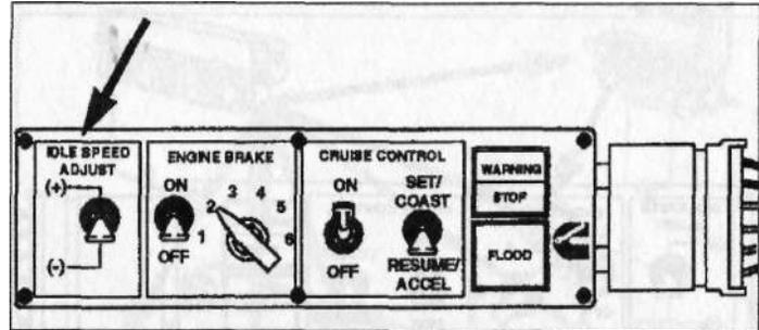
Кратковременное перемещение переключателя в положение минус (-) снижает частоту вращения на холостых оборотах на 25 об/мин. В свою очередь, перемещение переключателя в положение (+) увеличивает частоту вращения на холостых оборотах на 25 об/мин.
