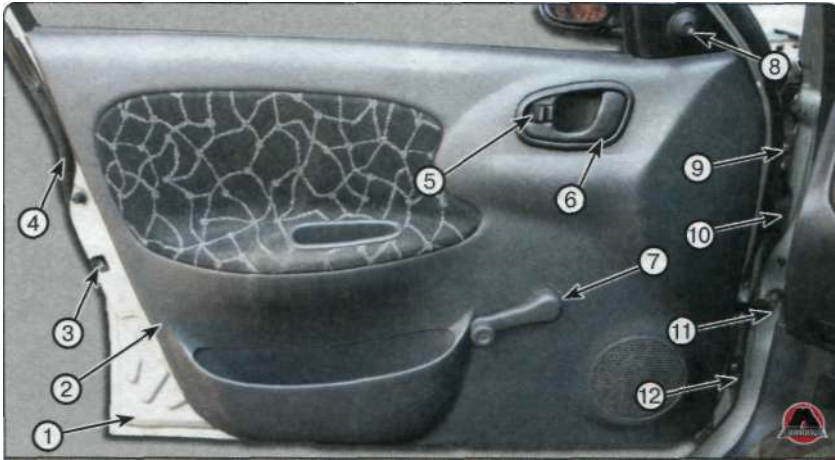
1. Дверь. 2. Обивка двери. 3. Замок двери. 4. Уплотнитель двери. 5. Кнопка за- пираания/отпираания замка двери. 6. Внутренняя ручка открывания двери. 7. Руч- ка привода стеклоподъемника. 8. Ручка регулировки наружного зеркала заднего вида. 9. Верхний навес двери. 10. Пыльник жгута проводов. 11. Ограничитель от- крывания двери. 12. Нижний навес двери.
