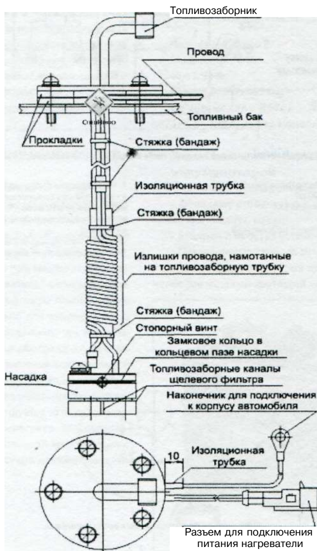
Монтаж насадки на топливозаборнике.
