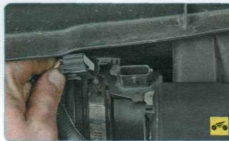
5. Нажмите на фиксатор колодки жгута проводов и отсоедините колодку от разъема датчика массового расхода воздуха.
