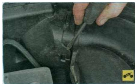
6. Поддев отверткой, извлеките трубу воздухозаборника из корпуса воздушного фильтра...
