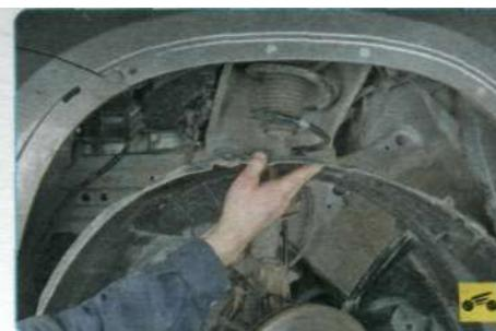
8. Снимите подкрылок правого переднего колеса (см. «Снятие и установка брызговиков колес и подкрылков», с. 252).
