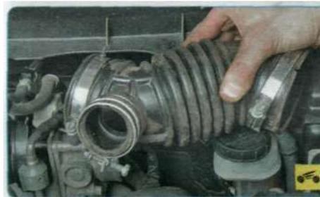
7. ...и снимите воздухоподводящий рукав.
