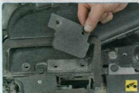
5. Снимите прижимную пластину.
