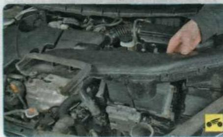
3. Снимите воздухозаборник (см. «Снятие и установка воздухозаборника», с. 98).
