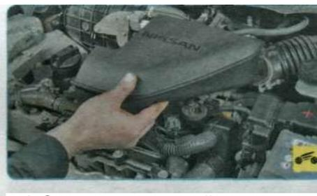
4. Снимите декоративный кожух двигателя и верхний резонатор впуска (см. «Снятие и установка декоративного кожуха двигателя и верхнего резонатора впуска», с. 64).
