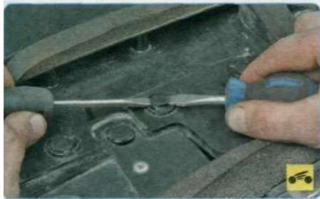
3. Подденьте отверткой фиксатор пистона на крепления воздухозаборника...
