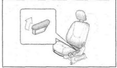
3. (Модификации) Регулировка поясничной опоры сиденья водителя. Для регулировки поясничной опоры перемещайте регулировочный рычаг, расположенный сбоку спинки сиденья, вниз (усиление) или вверх
