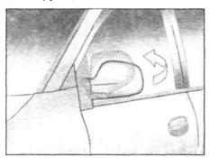
6. Некоторые модификации имеют дополнительную функцию - автоматическое складывание зеркал, которое производится нажатием на выключатель, показанный на рисунке. Для возвращения зеркал в рабочее положение нажмите на выключатель еще раз.
