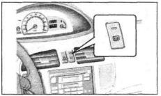
3. Обогрев стекол выключается автоматически через 20 минут. Чтобы выключить обогреватель раньше, повторно нажмите на выключатель.
