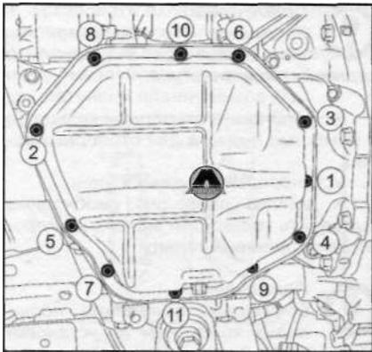
5. Отделить поддон картера двигателя с помощью приспособления для отделения картеров с силиконовыми уплотнительными прокладками (Mot. 1716).
