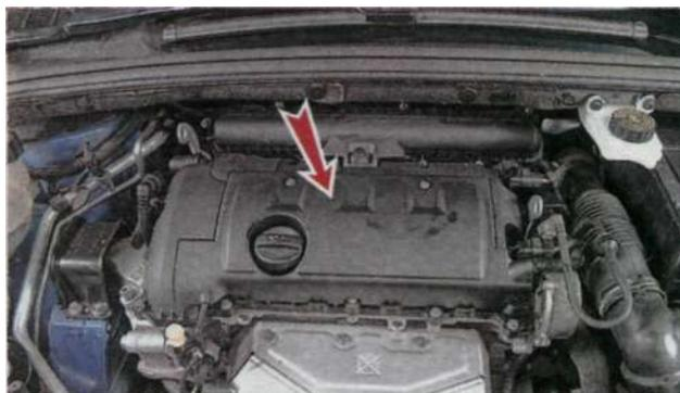
Корпусы свечей зажигания выполнены под **12-гранный** торцовый ключ **на 14 мм**. Для извлечения свечей из свечных колодцев необходим специальный свечной торцовый ключ, внутри которого установлена резиновая муфта (она удерживает свечу в ключе).
