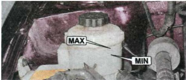
Если уровень рабочей жидкости находится ниже отметки **MIN**, то жидкость необходимо долить. Для этого нужно открыть крышку бачка, повернув ее против часовой стрелки...
