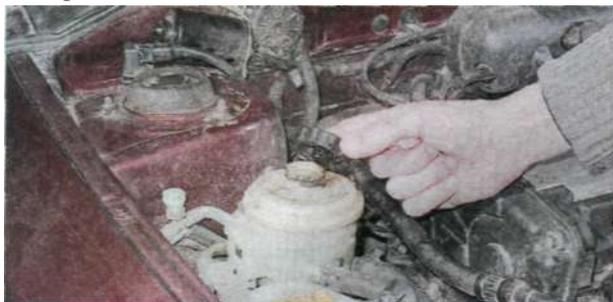
...и долить в бачок специальную жидкость, предназначенную для системы гидроусилителя рулевого управления (с. 239, «Справочные данные»).
