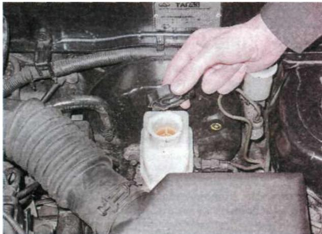
...и долить тормозную жидкость (с. 72, «Справочные данные»).
