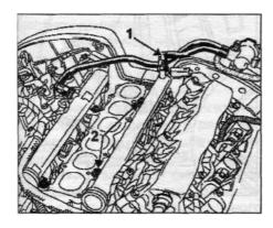
Для снятия топливораспределительной рампы необходимо снять впускной коллектор.
