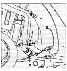
Отсоедините противонагнетательную трубку 1.
