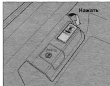
2. Откройте лючок заливной горловины топливного бака, нажав на рукоятку, которая расположена рядом с водителем сиденьем.
