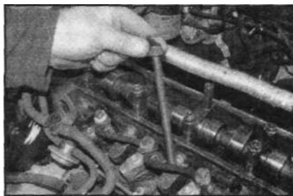
**11.27б.** ...и удалите болты крепления головки блока цилиндров.
