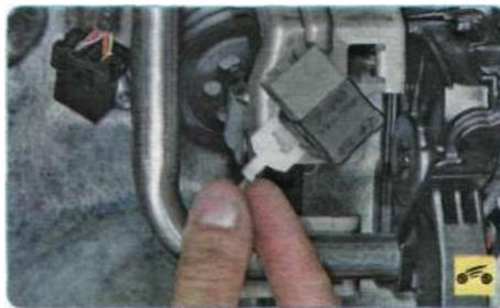
3. Вытяните запорную скобу выключателя стоп-сигнала.
