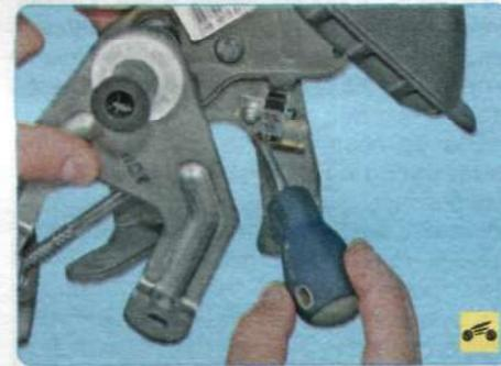
4. Выверните винт крепления (для наглядности показано на снятом рычаге стояночного тормоза)...
