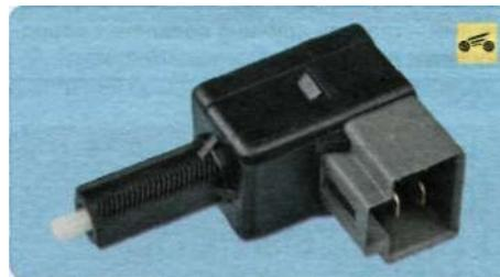
6. Вставьте выключатель стоп-сигнала в отверстие кронштейна до упора в педаль, поверните на 45° по часовой стрелке и зафиксируйте запорной скобой. Подсоедините колодку жгута проводов.
