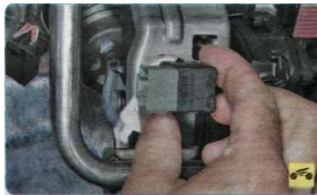
4. Поверните выключатель стоп-сигнала на 45° против часовой стрелки...
