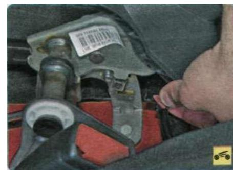
3. Отсоедините наконечник провода от выключателя сигнализатора включения стояночного тормоза.
