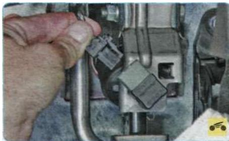
2. Отсоедините колодку жгута проводов от выключателя стоп-сигнала.
