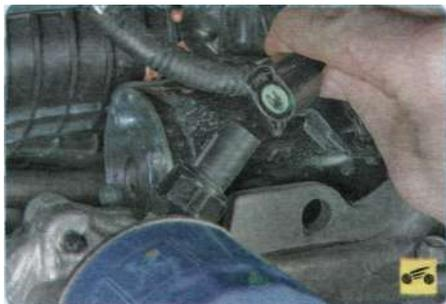
2. Отожмите фиксатор и отсоедините колодку жгута проводов от датчика давления масла.
