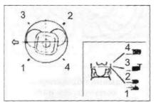
14. Установить поршень с шатуном в сборе в цилиндр, предварительно сжав поршневые кольца специальным приспособлением.
