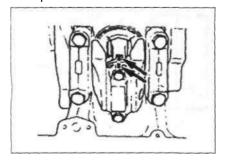
16.Смазать моторным маслом резьбу болтов и контактные поверхности шатунной крышки, после чего затянуть шатунные болты в два этапа установленными моментами затяжки.
