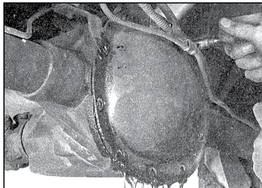
35.8b ...затем ослабьте усилие затяжки болтов верхней части и слейте трансмиссионную жидкость
