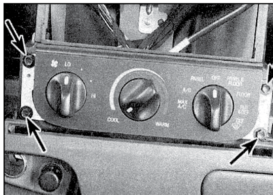
12.2 Предварительно сняв облицовку, выкрутите четыре винта (отмечены стрелками) и снимите пульт управления с лицевой приборной панели (система кондиционирования с ручным управлением)
