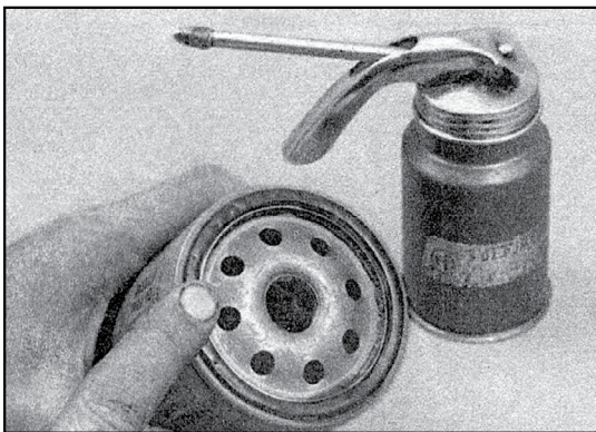
8.15 Перед установкой нового фильтра смажьте его уплотнитель чистым моторным маслом
