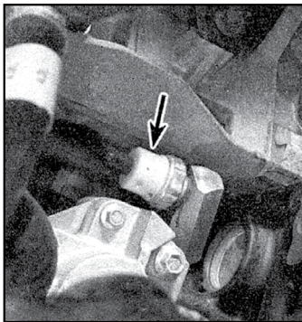
2.4б На двигателях V6 датчик давления масла (отмечен стрелкой) расположен слева спереди на блоке цилиндров
