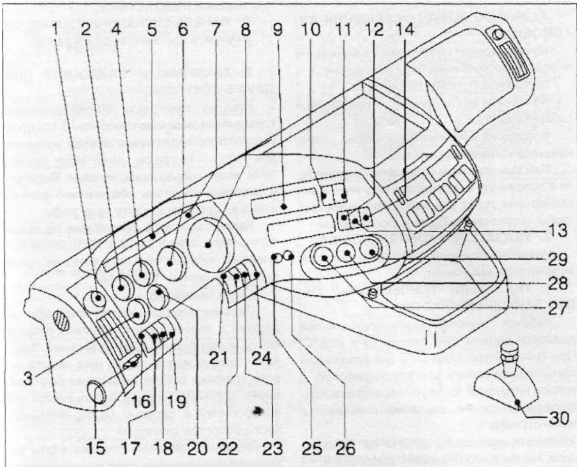
1. Выключатель освещения автомобиля и габаритных огней
