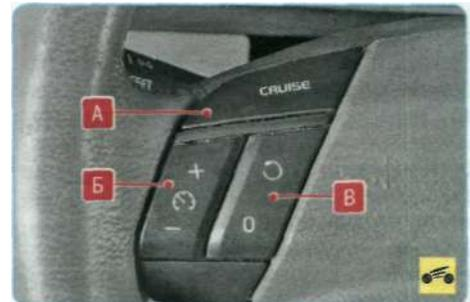
Система круиз-контроля активируется нажатием на клавишу А. При этом в нижней части дисплея одометра загорается надпись «CRUISE». Повторным нажатием на клавишу А система выключается.
