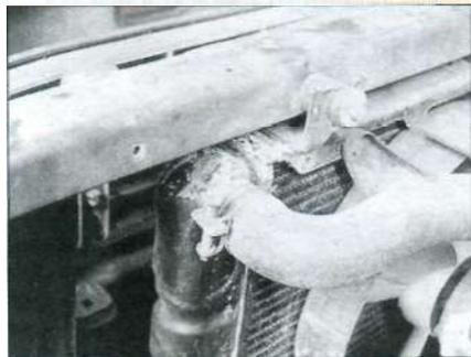
Утечки охлаждающей жидкости идентифицируются по характерным кристаллическим отложениям
