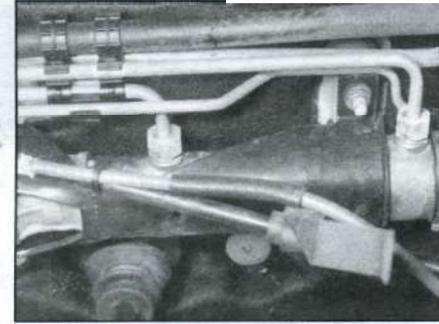
Жидкость может вытекать из неплотно затянутых или поврежденных шлицерных соединений системы
