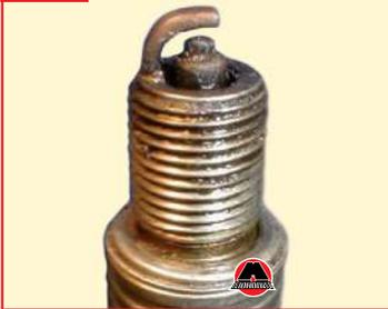
Свеча зажигания, показанная на фото №6, вывернута из неработающего цилиндра. Центральный электрод такой свечи, а также его юбка покрыты плотным слоем масла смешанного с каплями не-
