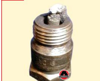
Свеча зажигания, изображенная на фото №8, имеет электрод, покрытый золотыми отложениями. При этом цвет отложений не играет решающей роли. Причина такого нагара – сгорание масла вследствие износа или залипания маслоотражательных поршневых колец. На двигателе наблюдается повышенный расход масла, из выхлопной трубы валит синий дым. Процедура замены поршневых колец описывается в главе «Механическая часть двигателя».
