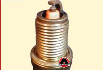
На фото №1 изображена свеча зажигания, вывернутая из нормально работающего двигателя. Юбка центрального электрода имеет светлоржавный цвет, нагар и отложения минимальны, полное отсутствие следов масла. Такой двигатель обеспечивает оптимальные показатели расхода топлива и моторного масла.
