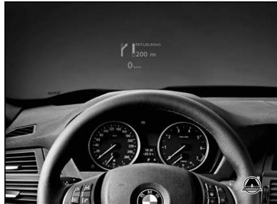
В качестве опции предлагаются также системы проекционного отображения на лобовое стекло - Head-Up дисплей. В нем информация относительно параметров движения, например, скорость или подкачки на выключенной системе, эргономично отображаются прямо на лобовом стекле, непосредственно в поле зрения водителя.
